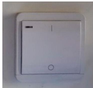
Aufklebbare Funkschalter, batteriebetrieben
